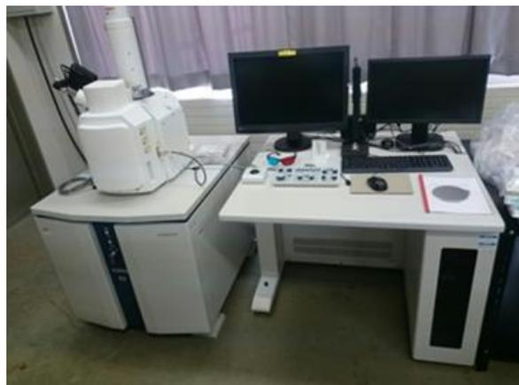
低真空対応走査型電子顕微鏡
