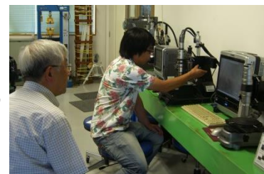
樹脂埋め金属サンプルの組織観察の様子
