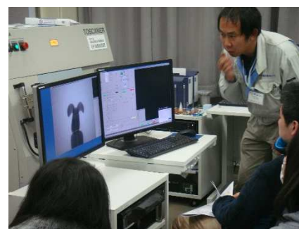
X線CTによる欠陥分析
