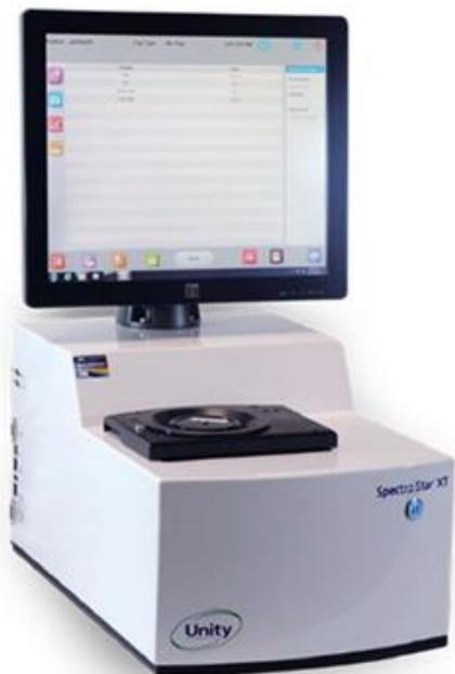
当センターでは、令和元年度補正ものづくり補助事業により、令和2年4月1日から食品表示法で義務化された各栄養成分を、近赤外分光法（Near-Infrared Spectroscopy、NIR）を用いた方法で迅速に測定できる装置を整備しました。
